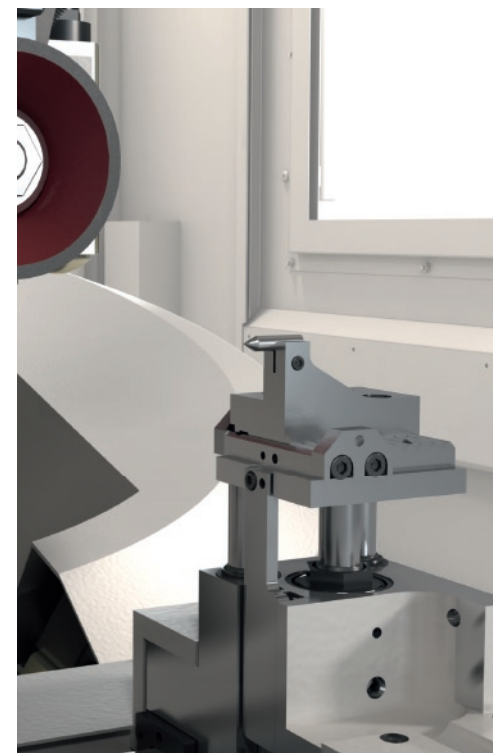
CNC-Lünette in verschiedenen Ausführungen
